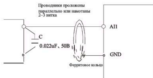
Рис. 3-18 Схема подключения аналогового входного терминала
