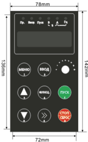
Установочные размеры защелки клавиатуры: 136*72мм
